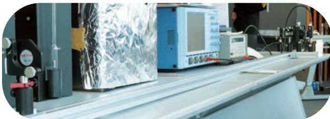
光は進む速さが決まっているので、同じ光源から出た光でも、長い距離を進んだ光と短い距離を進んだ光とでは到着する時間に違いが生じます。現代の計測技術では、わずかな到着時間の差も検出できます。今回は約4メートルの距離の差により生じた光の到着する時間の遅れ(約1億分の1秒)を実際の測定装置で読み取り、光の速さを計算しました。
